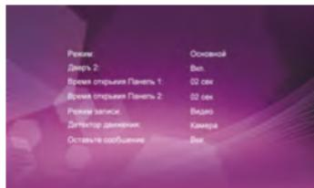
**[Режим]:** Основной и Дополнительный. Основной режим означает, что устройство подключено к внешней вызывной панели или камере. Дополнительный режим означает, что устройство подключено к основному или дополнительному внутреннему устройству.
