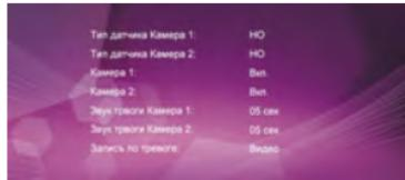
**[Тип датчика]:** Каждая камера имеет I/O статус (см. пояснение ниже), который означает, что при активации режима тревоги (детекции движения по внешнему датчику), монитор начнет запись видео или фото с соответствующей камеры.
